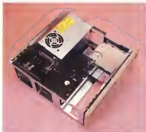
A sinistra una vista d'insieme del computer aperto. Lo spazio libero accanto al drive può ospitare una o due schede di espansione. A destra un particolare dell'8088 e dello zoccolo vuoto per l'8087; si nota anche il pin a bottone che mantiene in vita l'integrità dell'indirizzo interno.
